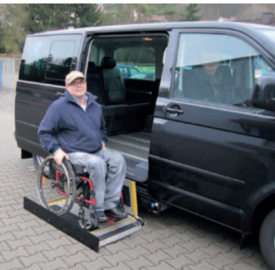
Einstieg über einen Kassettenlift.
